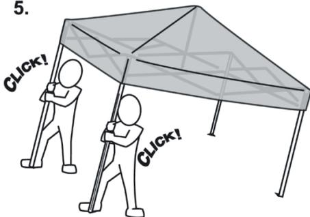
Hebt jedes Bein an und schiebt die untere Beinverlängerung heraus, bis diese in der ersten Stellung einrastet.
